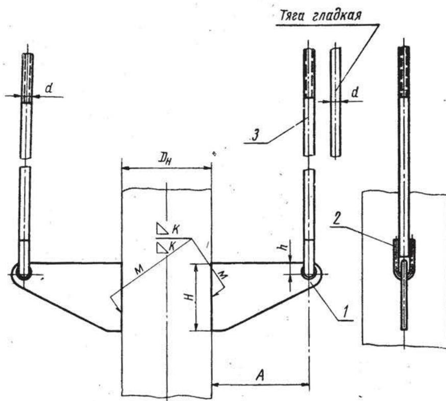
Пример обозначения блока подвески для трубопровода  $D_h=68$  мм с тягой  $d=M10$ :
