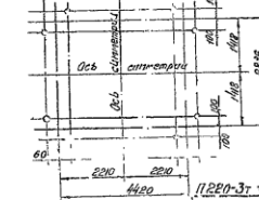
План расположения анкеровых болтов для опор ПС 220-3
